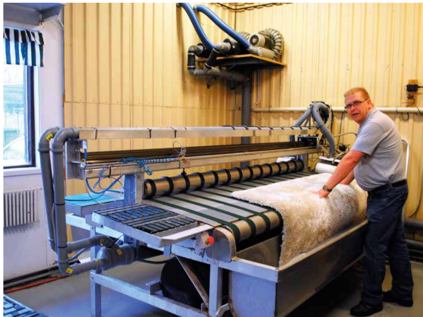
Laakavesipesukone selvittää käsinsolmitut matot ja muut, joita ei voida rumpukoneissa pestä. – Yksityisasiakkaat ovat matto-puolellakin suurin asiakasryhmä, kertoo uusi pesulayrittäjä Rami Seppälä.
